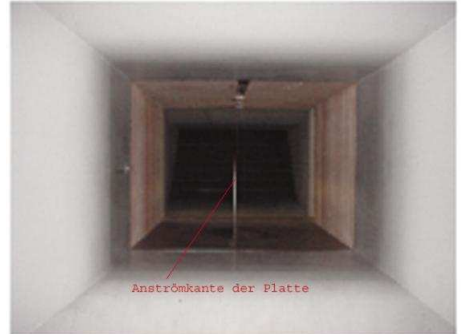
Abb. 2: Experimentierstrecke des Windkanals mit ebener Platte zur Untersuchung des Transitionsprozesses in der anfangs laminaren Grenzschicht der Platte.
